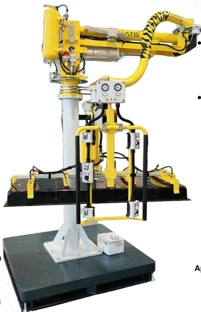
La configurazione personalizzata del manipolatore ATISmirus 100 con sistema di presa a ventosa è stata specificamente progettata per rispondere alle esigenze di movimentazione di coperture metalliche. La flessibilità dimensionale della ventosa, unita alla portata del manipolatore, permette di gestire il processo in modo sicuro ed efficiente.
